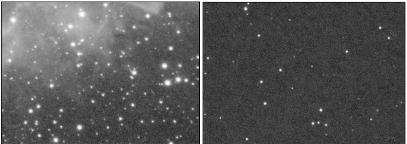
À gauche, phénomène courant : le bruit haute fréquence qui ressemble à de la neige sur l'image. À droite, moins courant, le bruit moyenne/basse fréquence qui se présente sous l'aspect de taches sombres sur l'image :
