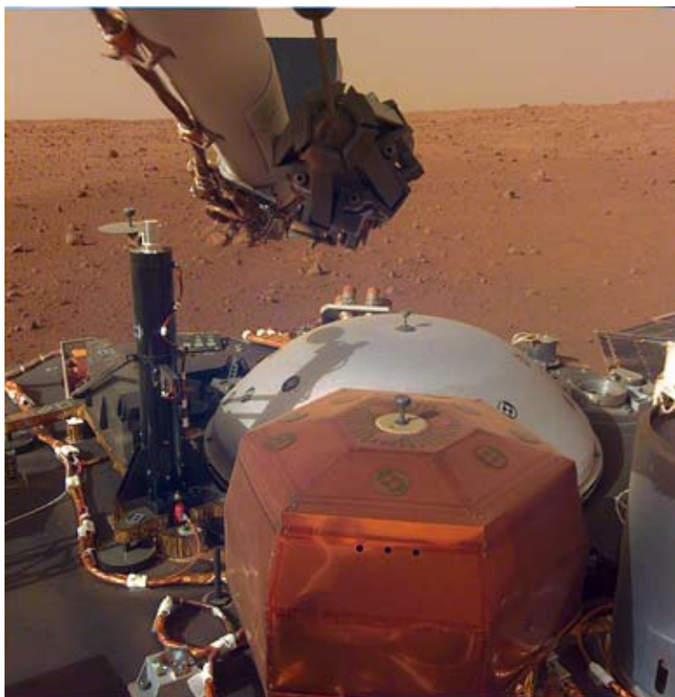
Sur cette photo prise le 4 décembre, on voit le sismomètre SEIS en rouge, la cloche blanche qui doit le recouvrir, le capteur de flux de chaleur (HP3) en noir et l'extrémité du bras sur lequel est installée la caméra. Crédit NASA
